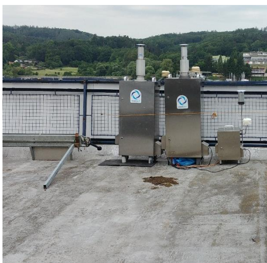
Obrázek 4 - vzorkovače Leckel. Vlevo vzorkovače Leckel SEQ 47/50 (PM 2,5 , jeden záložní), vpravo vzorkovač Leckel MVS6 (částicová analýza)
