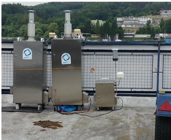
Obrázek 68 - Nízkoobjemový vzorkovač Leckel MVS6, vpravo jeho umístění s ostatními vzorkovači Leckel na brněnské přehradě (zcela vpravo)
