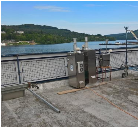
Obrázek 4 – vlevo vzorkovače Leckel, vpravo vzorkovač Leckel MVS6 (částicová analýza)
