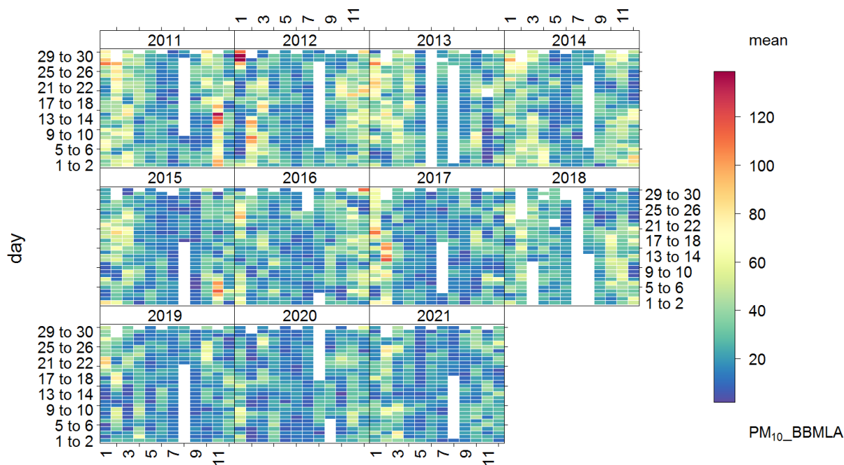
Obrázek 224 - heatmapa koncentrací průměrných denních koncentrací PM 10 pro stanici Brno-Lány za období 2011 až 2021 s využitím gradientní škály.
