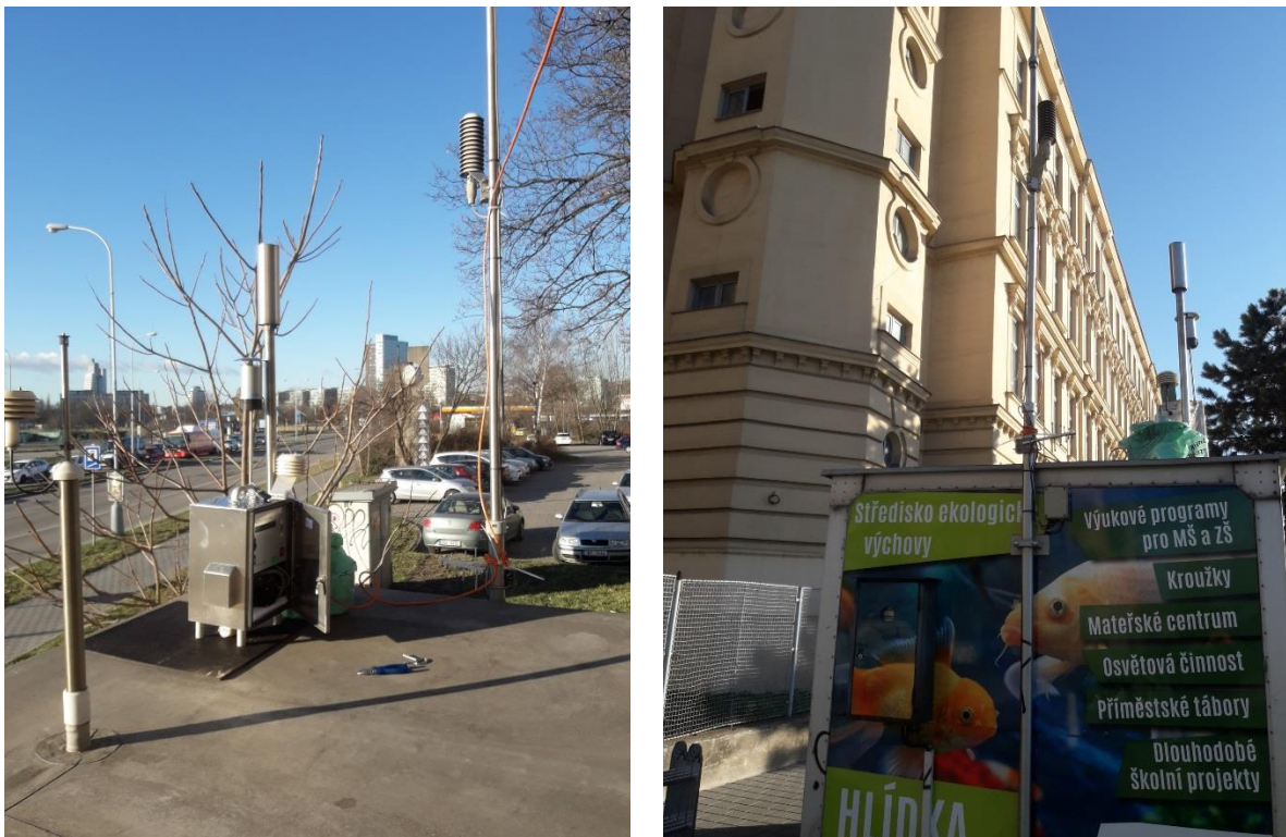
Obrázek 25 – umístění vzorkovače na střechu kontejneru automatické stanice imisního monitoringu (AIM) během paralelního kontrolního vzorkování, 5. března 08:00. Foto: Radek Krymlák, ČHMÚ Brno.
